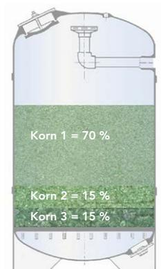
Bei Filtern mit weniger als 1'000 mm Durchmesser kann anstelle von Korn 3 auch Korn 2 verwendet werden. Auch bei allen DIN Filtern mit Düsenboden kann auf Korn 3 zu Gunsten von Korn 2 verzichtet werden.
