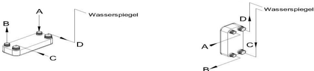
Installation unterhalb des Wasserspiegels
