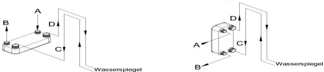
Installation oberhalb des Wasserspiegels
